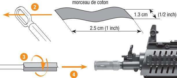
Enclenchez la sûreté (position « SAFE ») et retirez le chargeur et la batterie. Préparez une tige fine d'environ 45 cm. Placez un morceau de coton à son extrémité et nettoyez le canon en ajoutant quelques gouttes d'huile de silicone.
