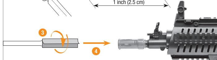
Coloque el seguro en posición de bloqueo y extraiga el cargador y la batería. Prepare una varilla fina de una longitud aproximada de 45 cm. Ponga un trozo de gamuza de algodón en su extremo y límpie el cañón con una pequeña cantidad de aceite de silicona.
