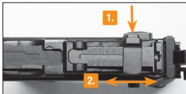
Para ajustar alza (única elevación), presione y sostenga los botones, y deslice hacia adelante y hacia atrás
