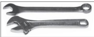
**PASO 1:** Instalar un conector requiere de dos llaves – una para la manguera y la segunda para los accesorios. La llave para la manguera es de 14 mm. La llave para los accesorios dependerá de estos.
