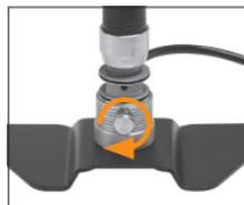
**ÉTAPE 5:** Serrez la valve de purge avec les doigts (n'utilisez pas les mains) en la tournant dans le sens des aiguilles d'une montre.
