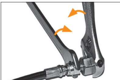
**PASO 2:** Use las llaves para ajustar la manguera a los accesorios, luego gire la llave de la manguera en dirección a las manecillas del reloj y la llave de los accesorios en dirección contraria a las manecillas de reloj hasta que
