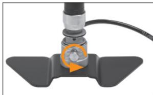
**PASO 6:** Una vez que usted termine y **ANTES DE DESCONECTAR LA MANGUERA** de cualquier accesorio que esté llenando, lentamente suelte la válvula de evacuación para soltar cualquier presión que haya quedado atrapada en la manguera.
