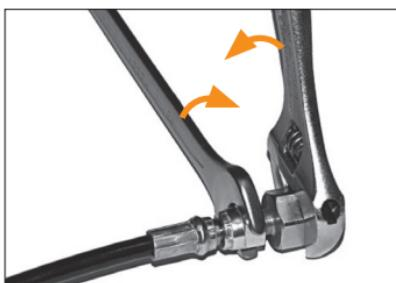
**ÉTAPE 2:** Utilisez les clés pour maintenir le tuyau et le raccord en place et ensuite, tournez la clé pour le tuyau dans le sens des aiguilles d'une montre et la clé pour le raccord dans le sens contraire des aiguilles d'une montre jusqu'à ce que le
